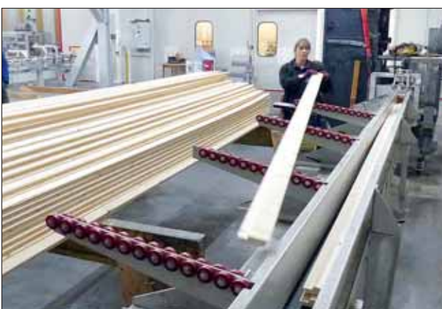
Manuelles Auflegen der stapelweise bereitgestellten Hölzer auf das Zuführsystem zur Lackierung.
