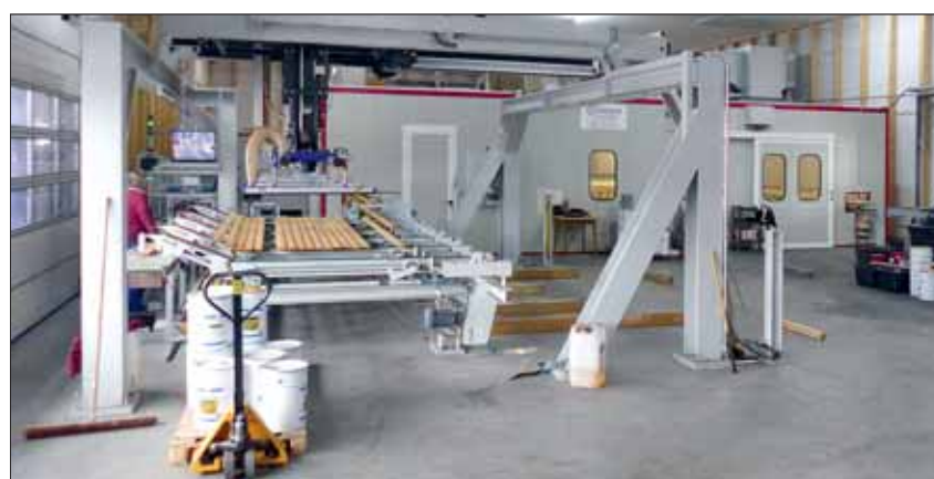
Blick auf den Trockentunnel, davor das Vakuumportal mit Hölzern auf dem Lagerbildungsförderer. Dieses sorgt für Flexibilität im Produktionsprozess, ...
