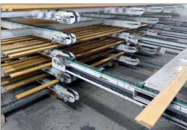
Lackierte Hölzer werden automatisch per Schwenkförderer in den Etagentrockner eingestapelt und dort forciert getrocknet.
