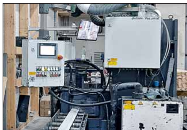
Die Lackierung der Hölzer erfolgt automatisch im Durchlauf im „Vacumat“.
