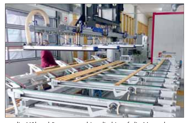
... die Hölzer können von hier direkt auf die Verpackungsstrecke (links) aufgelegt, oder zur Zwischenlagerung lagenweise zu Stapeln neben der Anlage aufgesetzt werden.
